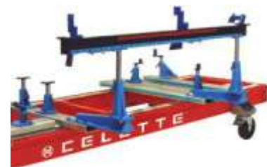
MZ+ 오버헤드 사이드지그 9113.063 도어, 루프, 측면 측정을 위한 사이드 지그 시스템 별도의 크로스멤버 필요
